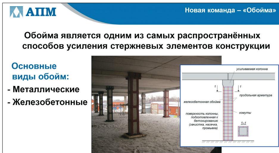
Рис. 9. Использование Обоймы в строительных конструкциях
