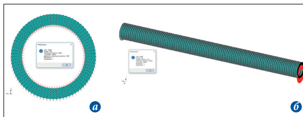
Рис. 10. КЭ-модель балки с кольцевым поперечным сечением: а — внутреннее давление; б — изгиб
