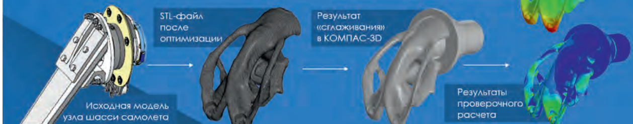
Рис. 15. Пример применения топологической оптимизации
