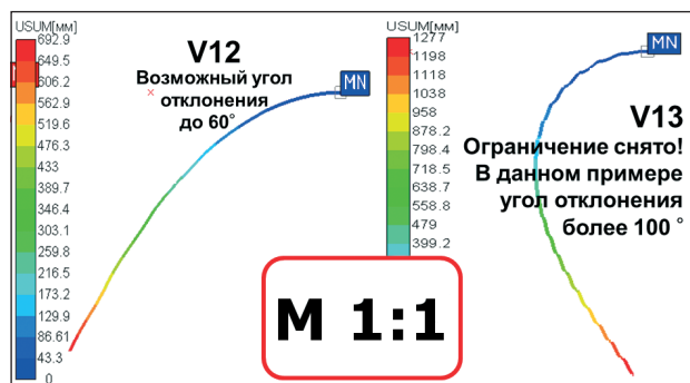
Рис. 13. Пример вывода результатов нелинейного расчета. Карты суммарных перемещений в масштабе М 1:1
