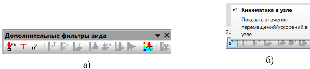
Рисунок 6.3 – а) Панель дополнительных фильтров вида; б) переключатель показа значений кинематической нагрузки в узлах модели
