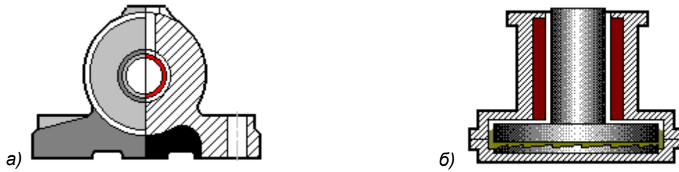
Рис. 1.1 Конструкция радиального (а) и упорного (б) подшипников скольжения.
