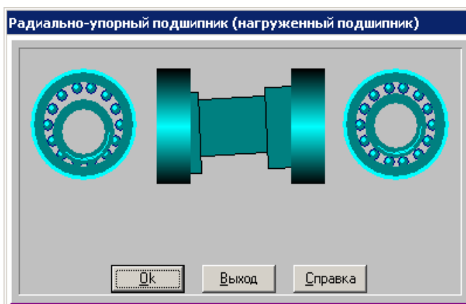
Рис. 1.12 Фрагмент анимации движения для шарикового радиально-упорного подшипника.
